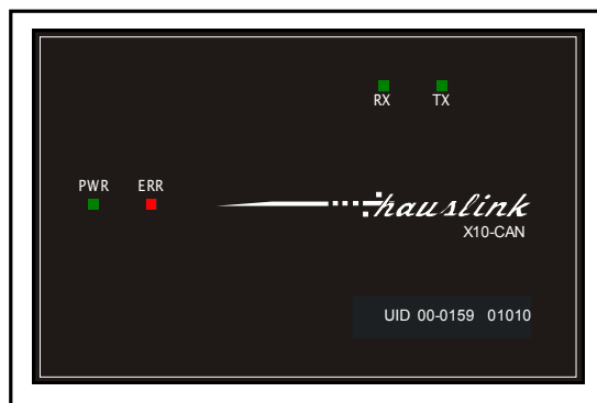
Рис. 4-1 Расположение светодиодов на лицевой панели устройства
